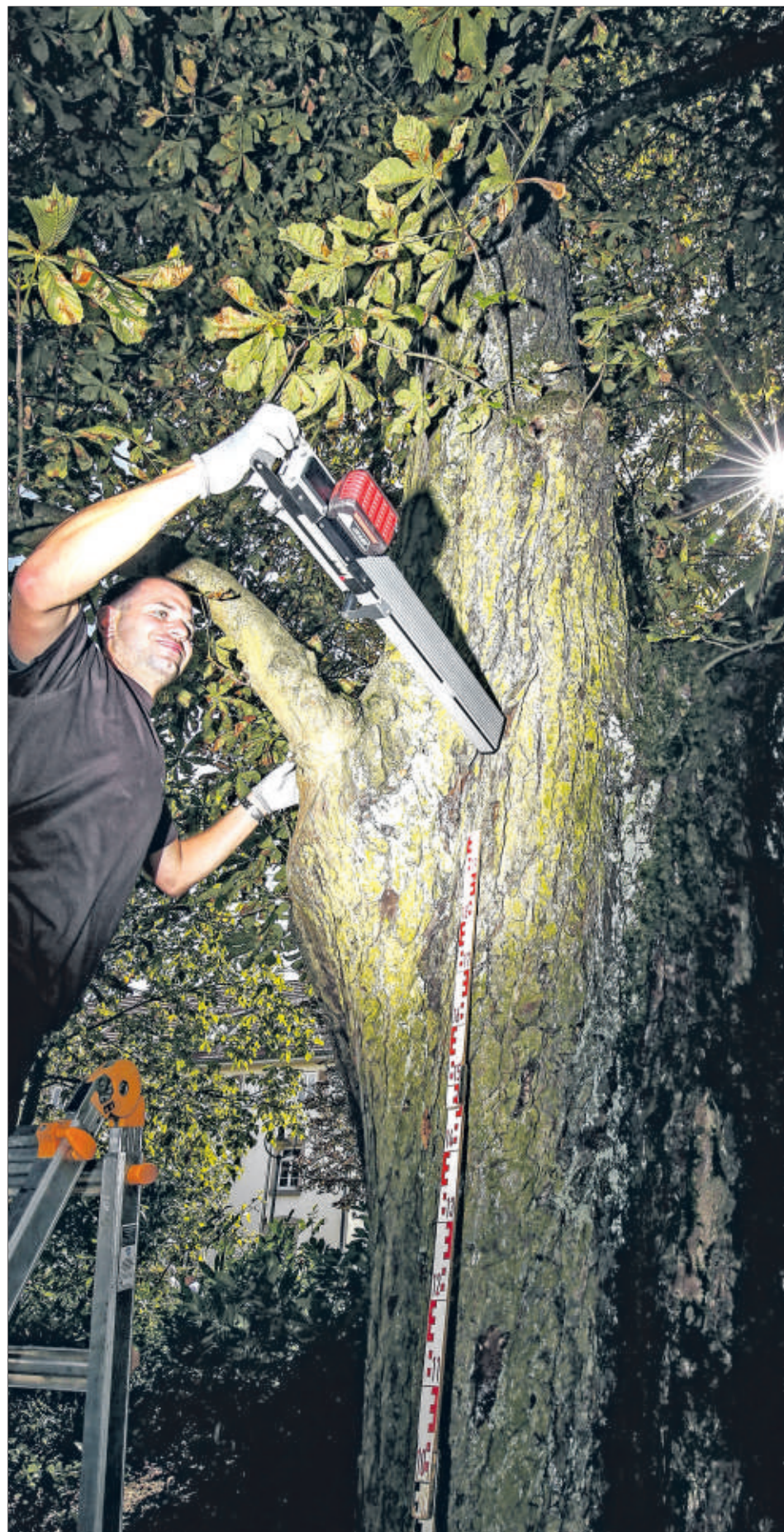
Mit einem Bohrwiderstandsmessgerät untersucht Heiko Münzing, ob ein Baum gesund ist oder von innen heraus faul.
